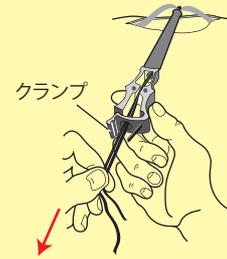
③ 引き棒を取り外し、テープを手前に引いて閉塞に必要な最低張力の所で、クランプ部を操作して保持する。
